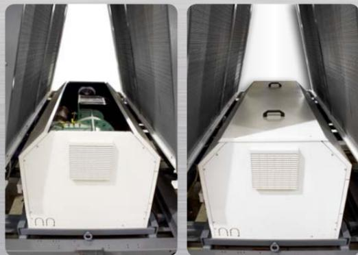
Die Verdichterhauben reduzieren durch die Verwendung schallschluckenden Materials drastisch die Lärmemission. Die Verdichtergehäuse sind auf Gleitschienen **ausziehbar**: die Wartungsarbeiten sind dadurch merkbar vereinfacht. Die Kompressoren können auch von oben am Haken mittels Kran demontiert werden.
